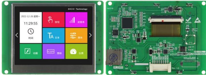
图 1-1 3.5 寸无触摸参考图
