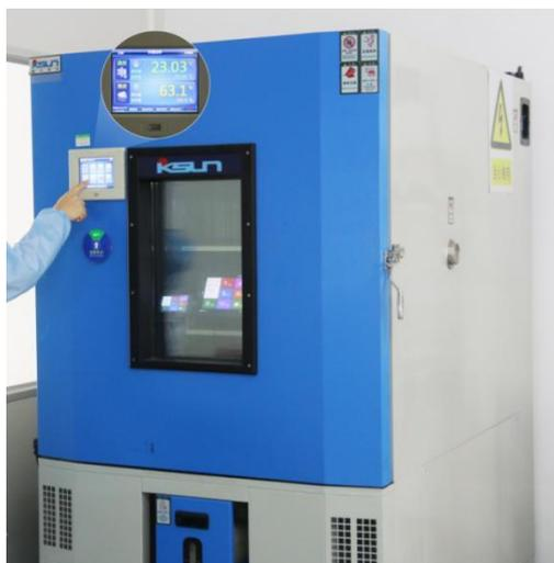
图 5-3 高低温老化测试图
